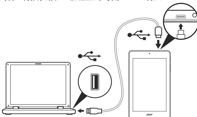
3. 向下轻扫左上通知区域，点按 **Connected as a media device**（连接为媒体设备），选择是要连接为 *Media device (MTP)*（媒体设备 (MTP)）（默认选项）还是连接为 *Camera (PTP)*（相机 (PTP)）。
